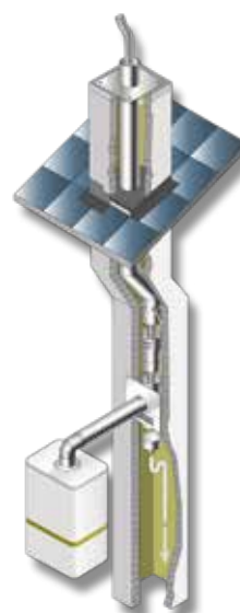
FLEX INTUBATO IN MONOPARETE ESISTENTE
