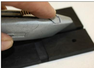
Immagine #1. Tagliare l'AV Pad a misura per il montaggio orizzontale
