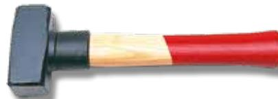
Mazzetta da muratore con collare salvamanico di sicurezza a norme DIN, in acciaio C45 temperato a induzione DIN 1193, levigata lateralmente, verniciata a forno, con battenti lucidati.
