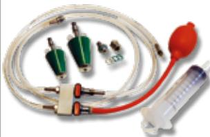
Per la verifica della tenuta degli impianti di distribuzione gas secondo le normative UNI 7129 e UNI 11137, fornito con raccordi, rubinetti, siringa, pompa.
