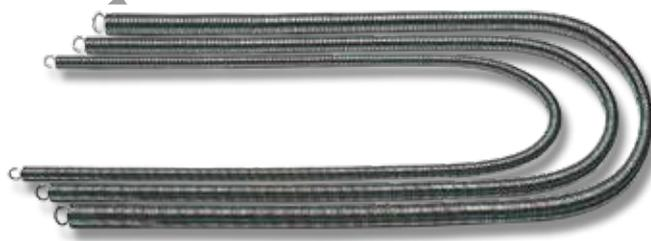
Realizzate in acciaio con filo quadro per la curvatura di tubi multistrato. La spirale deve essere inserita nel tubo da curvare.
