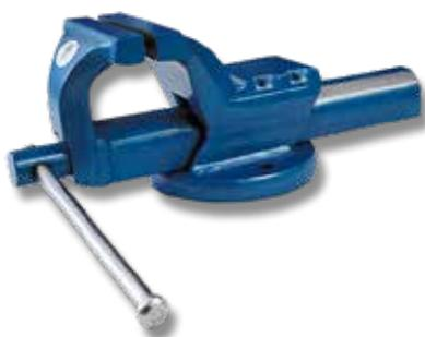
Da banco in acciaio saldato, ganasce zigrinate, temprate ad induzione e rettificate ( durezza HRC 45/48 ) lunghezza ganasce 125 mm.
