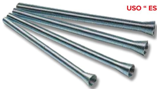
Realizzate in acciaio per la curvatura di tubi in rame ricotto. La spirale deve calzare il tubo di rame da curvare tramite l'imboccatura della stessa.
