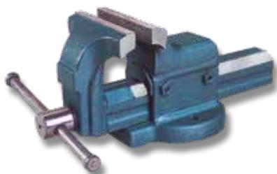
Costruita interamente in acciaio forgiato C43, doppia guida prismatica registrabile, ganasce zigrinate, temprate ad induzione e rettificata (durezza HRC 45/48). Larghezza e apertura (A) ganasce: vedi versione
