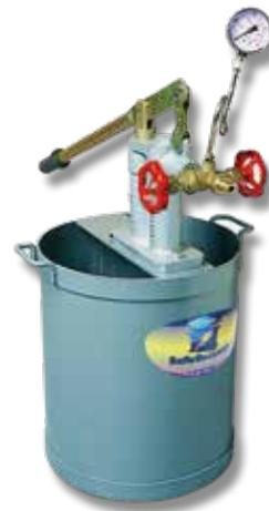
Funzionamento manuale realizzata in lamiera pesante verniciata con capienza di 38 lt. Corpo pompa in ghisa correato di serpentina, rubinetti esterni e manometro per prove e collaudi fino a 100 bar.
