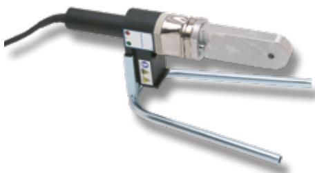
Saldatore manuale adatto alla polifusione a bicchiere di tubi e raccordi in PE - PP - PPR - PB - PVDF mediante bussole teflonate. **Segnalazione acustica e luminosa al raggiungimento della temperatura di lavoro e all'eventuale insorgere di anomalie.**
