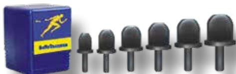
Realizzati in acciaio temperato, sono idonei alla lavorazione dei tubi per allargare, calibrare e flangiare conservando la malleabilità del materiale durante l'intero processo. Gli utensili SPIN lavorano su tubo rame crudo, cotto, ricotto ed alluminio e sono adatti per tutti i trapani o avvitatori (1800 RPM 18V consigliato).
