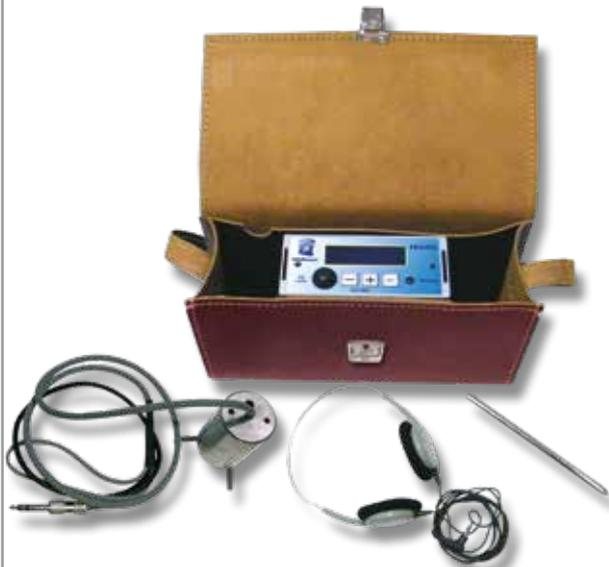
Per la ricerca di perdite di liquidi in pressione su impianti idrici, di riscaldamento e antincendio. Con comandi Soft Touch, visualizza l'intensità del segnale sul display e tramite le cuffie in dotazione. Autolimitazione decibel per una maggior tutela dell'udito dell'operatore, sonda piezoceramica preamplificata, rapida accensione tramite il jack delle cuffie, alimentato con batteria 9V, dotato di puntale per il preascolto di valvole, pompe e circolatori.
