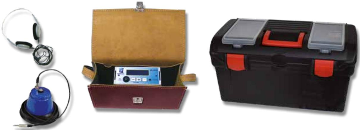
Kit per la ricerca di perdite di liquidi in pressione su impianti idrici, di riscaldamento e antincendio. Dotato di geofono per amplificare la resa di ascolto in caso di ricerca anche in esterni.
