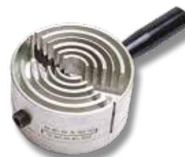
Si possono eseguire sbavature su tubi da Ø 25, Ø 32, Ø 40, Ø 50, Ø 56, Ø 63, Ø 75 mm
