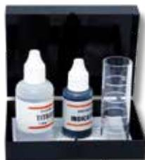
Per la misurazione della durezza dell'acqua.
