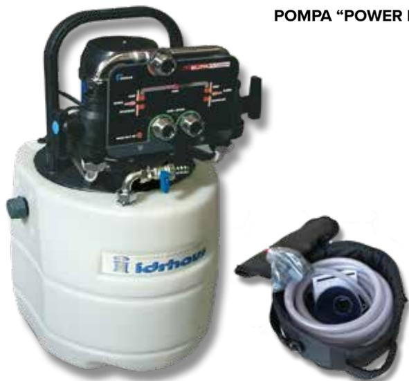
Ad asse verticale con serbatoio per una rapida pulizia di tutto l'impianto di riscaldamento e di refrigerazione. (Chiller) Dotata del nuovo invertitore di flusso **Powerflux**, che assicura più portata e più prevalenza, la pompa POWER ES, permette di eliminare i problemi di circolazione dell'acqua causati da accumuli di fanghiglia e depositi di calcare.
