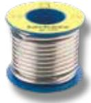
Saldante in filo di stagno e rame Ø 3: idoneo per impianti in rame di acqua fredda, calda e gas. Composizione: sn 97%, cu 3%. Ø 3, L-CU3 sn, temperatura di fusione 230-250 C°.
