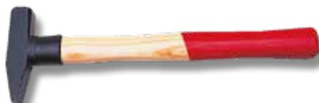
Con collare salvamanico di sicurezza a norme DIN, in acciaio C45 temperato a induzione DIN 1193, levigato lateralmente, verniciato a forno, con battenti lucidati. Bussola in nylon salvamanico, manico in frassino sagomato verniciato 1/2 rosso, bloccaggio con cuneo in acciaio e resina. Peso e lunghezza: vedi versione
