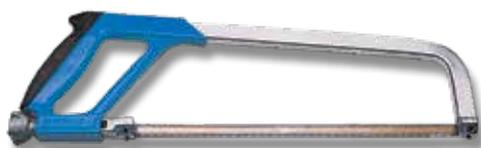
Massiccio archetto porta lama a 3 posizioni fisse sul telaio. Regolazione tensione lama sull'impugnatura con dispositivo a molla; telaio tubolare porta lama a sezione rettangolare con sede per inserimento lame di scorta.
