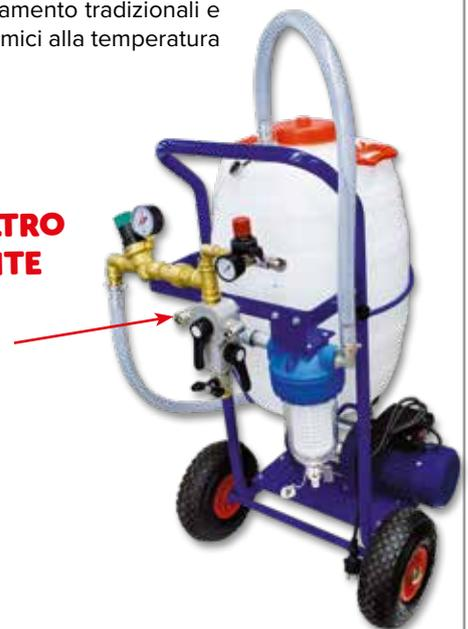
Collegamento aria con riduttore di pressione permette di miscelare aria e acqua per ottenere lavaggio flussato, spegnendo la pompa per circolazione dei liquidi permette di svuotare gli impianti con immissione di aria.
