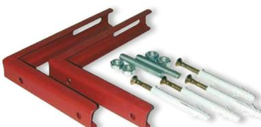
Costituito da due staffe di sostegno in acciaio verniciato asolate per facilitare il montaggio, due colonnine filettate M10, quattro dadi e quattro tasselli Ø 10 x 80 mm completi di viti per un sicuro ancoraggio alla parete.
