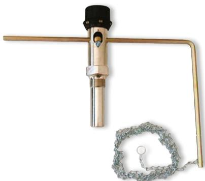
Il regolatore di tiraggio, controllando automaticamente l'aria comburente, modula l'intensità del fuoco alla richiesta dell'impianto, garantendo che l'acqua nella caldaia si mantenga alla temperatura desiderata e permettendo una sensibile economia di combustibile.
