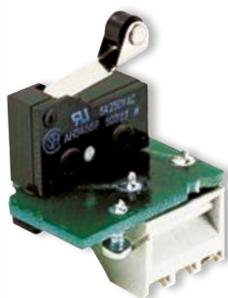
Contatto pulito "normalmente aperto" (NA), questo contatto si chiude solo quando l'attuatore viene alimentato. Alimentando l'attuatore, infatti, la valvola comandata passa dalla condizione di chiusura a quella di apertura; raggiunta la posizione di apertura completa, il microinterruttore, presente all'interno dell'attuatore, chiude il contatto pulito.
