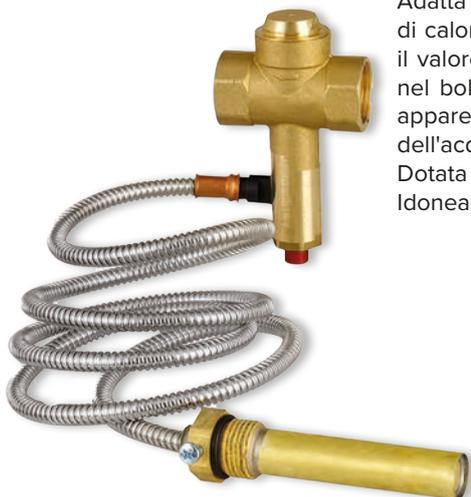
Adatta per limitare la temperatura dell'acqua nelle caldaie con bollitore o scambiatore di calore. Quando la temperatura dell'acqua, in cui è immerso il pozzetto, raggiunge il valore di 95° la valvola si apre scaricando l'acqua ad alta temperatura contenuta nel bollitore o nello scambiatore permettendo (dove è stato previsto con specifici apparecchi) l'ingresso di acqua fredda nell'impianto per riportare la temperatura dell'acqua nei limiti di sicurezza.
