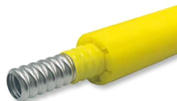
Nelle installazioni sotto traccia la normativa prevede che in presenza di pareti che contengano cavità le tubazioni CSST formabili devono essere inserite in una guaina. La soluzione sono tubazioni CSST per impianti gas già inserite in apposita guaina di colore giallo con particolare conformazione denominata "stellare".
