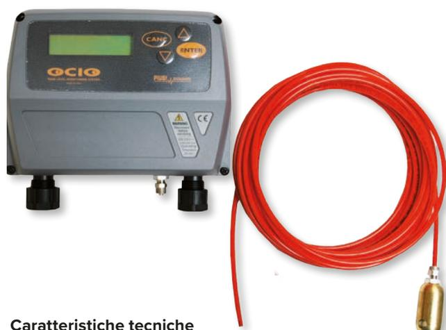
E' una apparecchiatura elettronica di misura e controllo del livello di serbatoi. Rileva il livello del serbatoio grazie all'elaborazione di una lettura di pressione, effettuata tramite una sonda calata all'interno del serbatoio.
